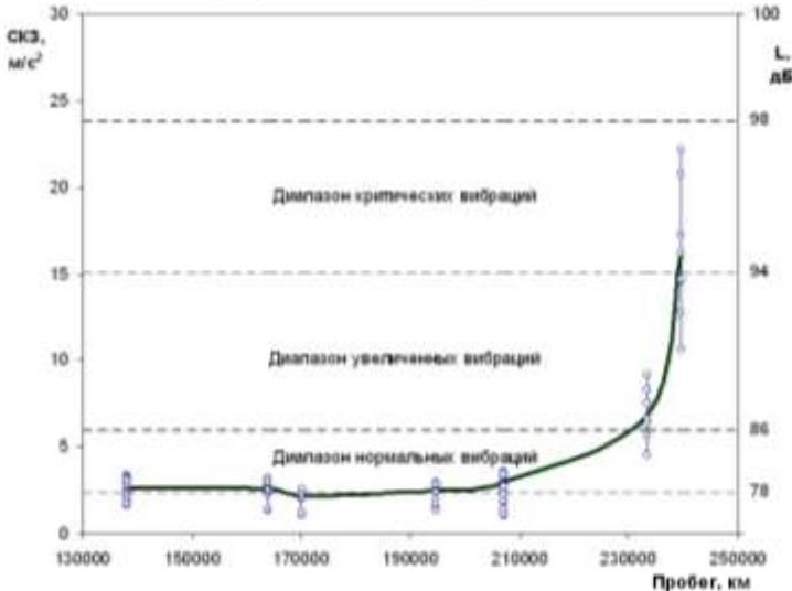
Рисунок 4 – Зависимость СКЗ виброускорений РМК от пробега
