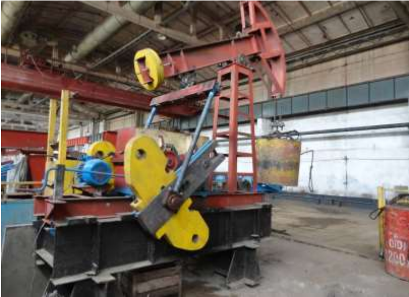
Рисунок 2 – Стенд-качалка для испытания трехступенчатого двухпоточного пакетного редуктора с U_{\Sigma}=64
