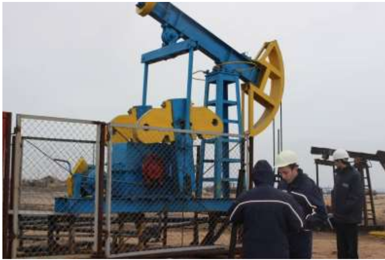
Рисунок 4 – Мониторинг работы станка-качалки СКД 3-1,5-710 с трехступенчатым двухпоточным пакетным редуктором с U_{\Sigma}=64 на промысле Пираллахы
