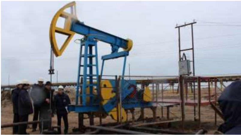
Рисунок 3 – Установка и пуск станка качалки СКД 3-1,5-710 с трехступенчатым двухпоточным пакетным редуктором с U_{\Sigma}=64 , на промысле Пираллахы
