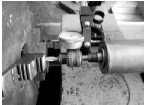
Рисунок 2 – Визначення жорсткості каната при стиску
