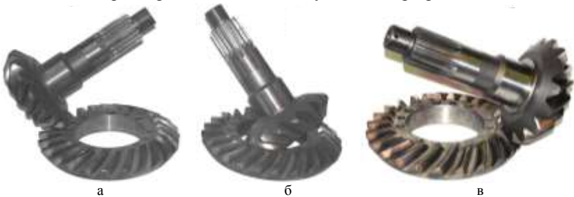
Рисунок 1 – Экспериментальные образцы конических зубчатых колес: а – без покрытия; б, в – с композиционным слоем
