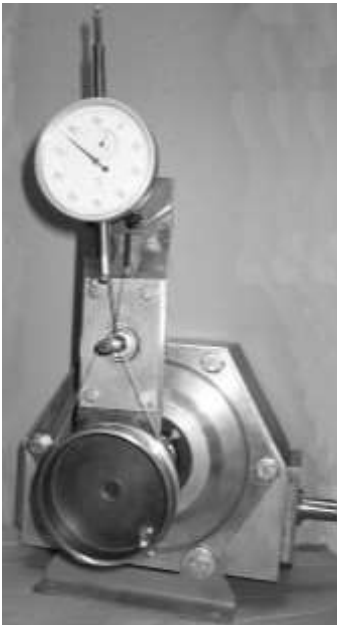
Рисунок 2 – Спіроїдний редуктор, налагоджений для перевірки закону руху механізму
