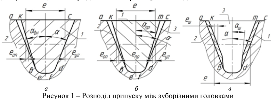
Рисунок 1 – Розподіл припуску між зуборізними головками
