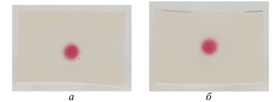
Рисунок 4 – Контактные отпечатки: а – полученные над промежуточным упругим слоем; б – полученные под промежуточным упругим слоем
