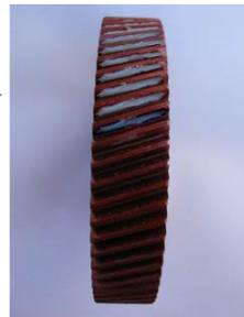
**Вывод:** Синтезированы квазиглобоидные зубчатые колеса за счет усовершенствования схемы формообразования резанием. Экспериментально получены квазиглобоидные зубчатые передачи, состоящие из квазиглобоидных колес сопрягающиеся с цилиндрическими колесами. Определена площадь суммарного пятна контакта квазиглобоидных зубчатых передач.
