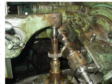
Рисунок 3 – Изготовление квазиглобoidного колеса
