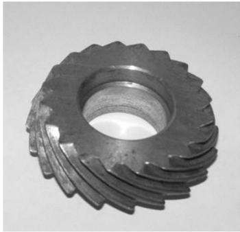
Рисунок 4 – Квазиглобоидное колесо с  $z_1=20$ ;  $m=1,5$ ;  $\beta=60^\circ$
