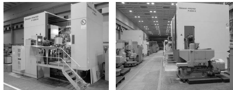
Рисунок 3 – Станки Gleason-PFAUTER в термоконстантном цехе
