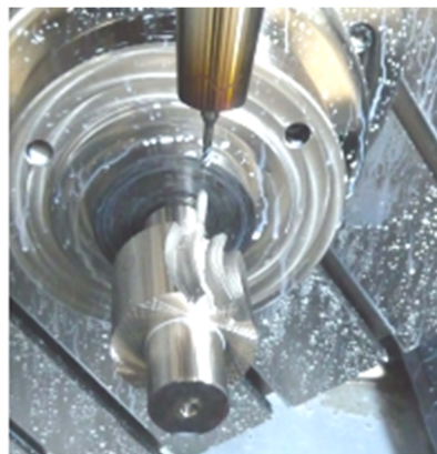
Рисунок 7 – Черновое фрезерование арочных зубьев
