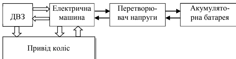
Рис. 2 – Структурна схема гібридної установки з електричною машиною потужністю до 25 кВт
