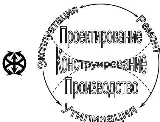
Рис. 4 – Обобщенная структурная схема жизненного цикла объектов техники и их взаимного влияния
