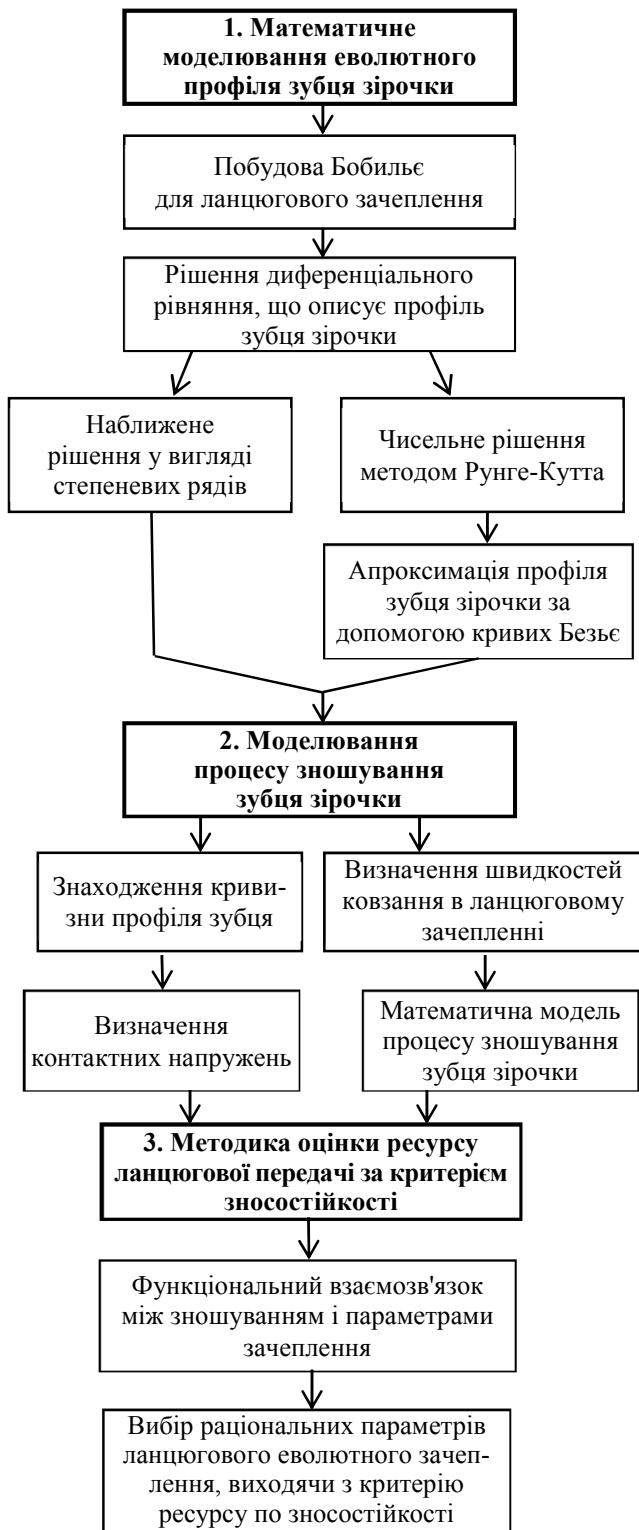
Рис. 1 – Алгоритм методики аналізу та підвищення ресурсу ланцюгової передачі за критерієм зносу профілю зубця
