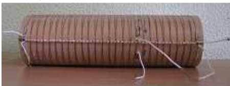
Рис. 4. Макет резистора для экспериментального определения индуктивности
