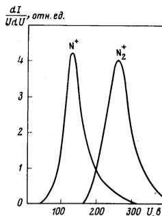
Рис. 6. Энергетические спектры ионов с разной массой.
