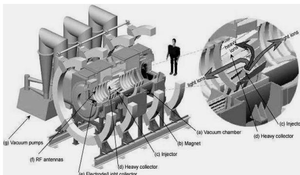
Рис. 7. Схема плазменного фильтра "Архимед".
