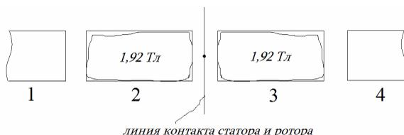
Рис. 2. Магнитная индукция на поверхности второго и третьего зубцов.
