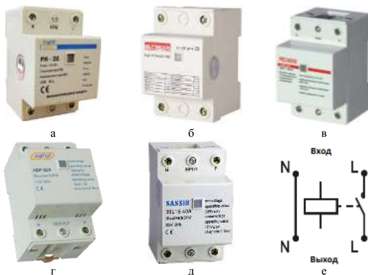
Рис. 1. Примеры конструктивных исполнений реле напряжения с двухцветной световой индикацией наличия напряжения на входе: а – серия РН [3] (АсКо-УКРЕМ, Украина), б – серия e.vrg.pro [4] (E-NEXT Украина), в – серия АЗМ [5] (Ресанта, Россия), г – серии Энергия HDP [6] (Энергия, Россия) и HDP [7] (МЕВА Electric, Китай), д – серия 3SL15 [8] (Sassin International Electric, Китай); е – схема подключения реле.
