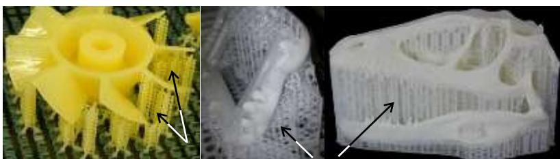
Рис. 4 – Поддерживающие структуры моделей при печати по SLA-технологии.
