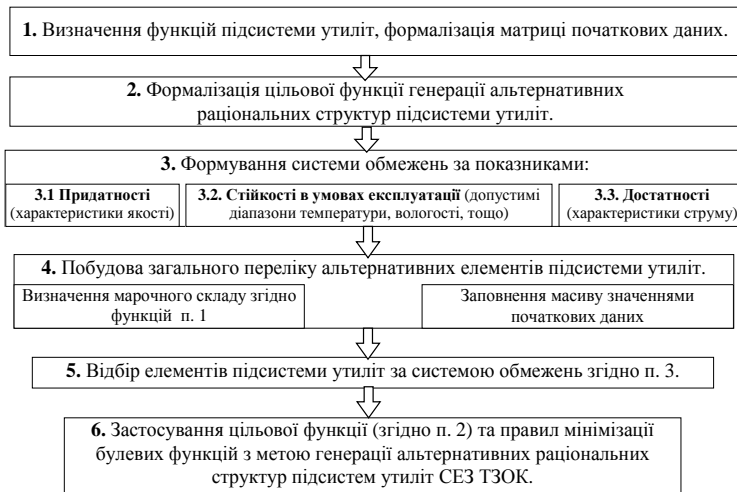
Рис. 2 – Загальний алгоритм опису методики структурного синтезу підсистем утиліт систем електрозабезпечення ТЗОК на ОВП ВДЕ
