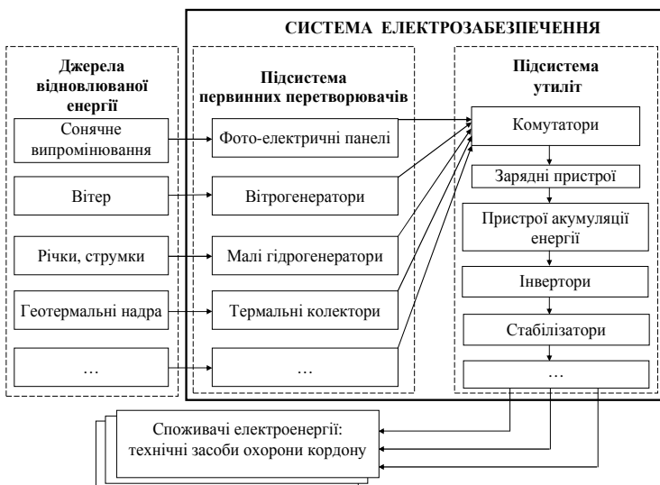
Рис. 1 – Структурна схема локальної СЕЗ на ОВП ВДЕ
