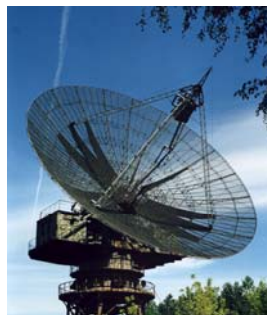
Радар НР с полноповоротной антенной
