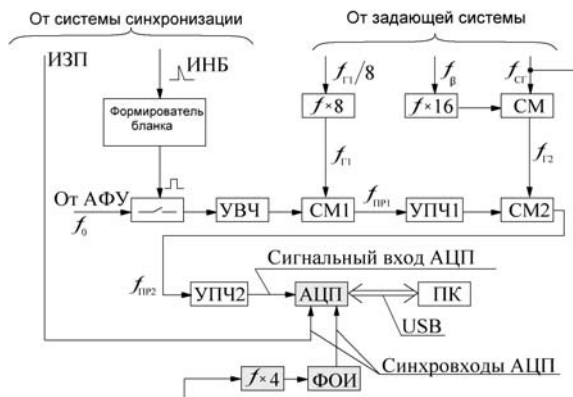
Рис. 3 – Функциональная схема системы приёма, преобразования и обработки сигнала. Здесь АФУ – антенно-фидерное устройство, УВЧ – усилитель высокой частоты; СМ – смеситель; УПЧ – усилитель промежуточной частоты, [f \times 4] – блок множителя частоты на 4; ФОИ – формирователь импульсов опроса АЦП; ИЗП – импульс запуска передатчика; ИБН – импульс начала бланка.
