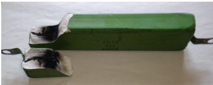
Рисунок 4 – Общий вид высоковольтного керамического объемного постоянного резистора типа ТВО-60-24 Ом, разрушенного на открытом воздухе при \theta_0 = 20 °С предельной импульсной электротепловой нагрузкой
