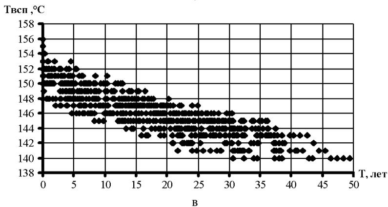
Зависимости температуры вспышки трансформаторного
