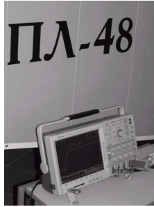
Рисунок 4 – Рабочее место для измерения импульсов высокого напряжения при помощи щупа высоковольтного Р6015А
