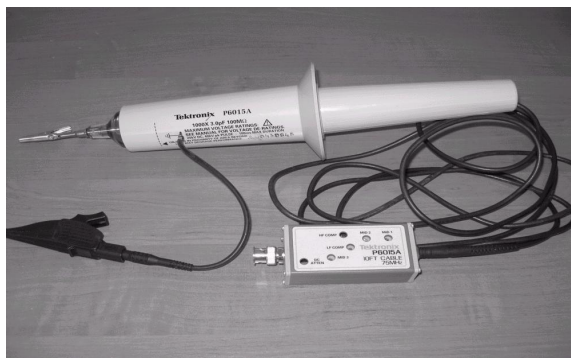
Рисунок 2 – Высоковольтный щуп P6015A
