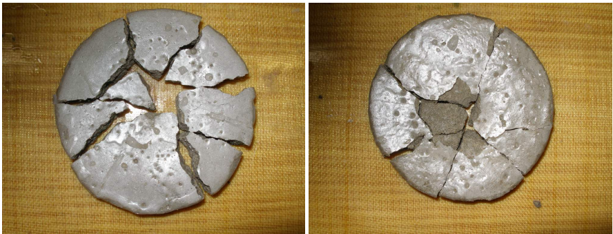
Рисунок 1 – Характер руйнування бетону: а – при дії імпульсу наносекундного діапазону; б – при дії імпульсу мікроросекундного діапазону
