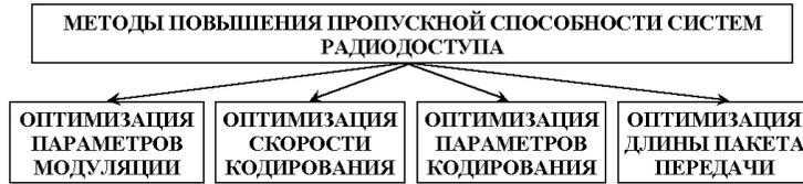
Рисунок1 – Классификация методов повышения пропускной способности СРД
