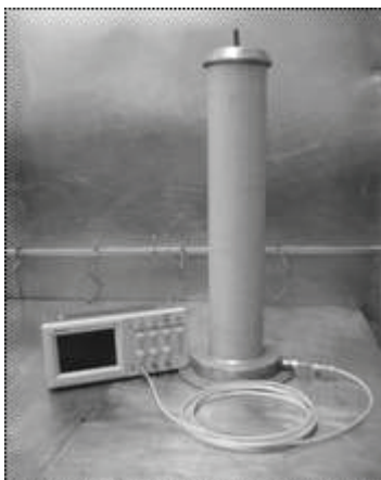
Рисунок 4 – Загальний вид омичного дільника імпульсів високої напруги ОДН-20
