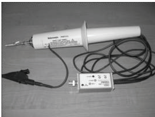
Рисунок 6 – Загальний вигляд змішаного дільника імпульсів високої напруги Tektronix P6015A
