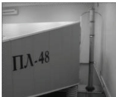
Рисунок 5 – Загальний вигляд омичного дільника імпульсів високої напруги ОДН-300
