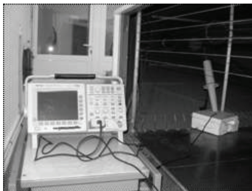
Рисунок 8 – Ввімкнення щупа високовольного P6015A між електродами СЛ-48
