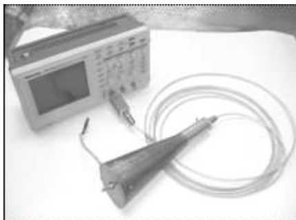
Рисунок 3 – Загальний вигляд змішаного дільника імпульсів високої напруги СДН-10
