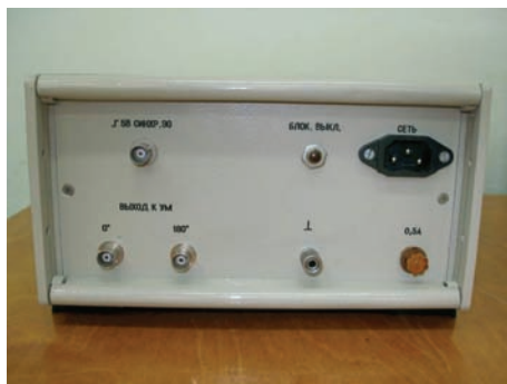
Рисунок 10 – Задняя панель генератора Г-ФНИЧ
