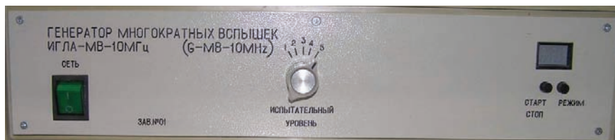
Рисунок 4 – Передняя панель генератора ИГЛА-МВ-10 МГц
