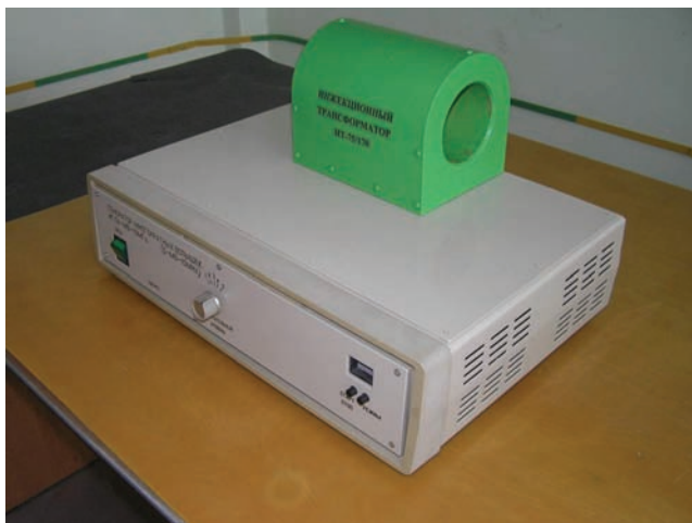
Рисунок 3 – Общий вид генератора ИГЛА-МВ-10 МГц с ИТ-75/170
