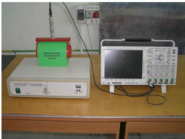
Рисунок 10 – Общий вид генератора во время исследования его выходных характеристик (с КК и ЭО)
