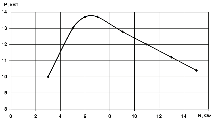
Рисунок 3 – Зависимость изменения потребляемой нагрузкой мощности от ее приведенного сопротивления
