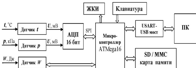
Рисунок 3 – Блок-схема системы мониторинга процесса синтеза наноуглерода
