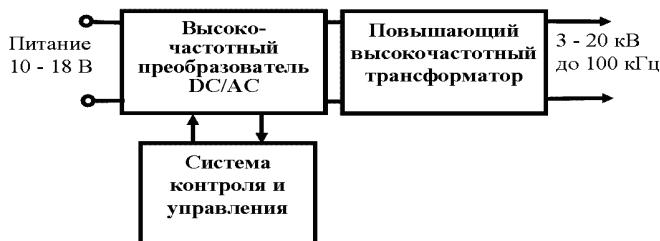
Рисунок 1 – Структурная схема управляемого импульсного генератора
