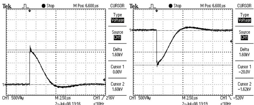
Рисунок 8 – Типовые осциллограммы испытательного напряжения 2 комплекта 5 уровня положительной и отрицательной полярностей (1600 В)
