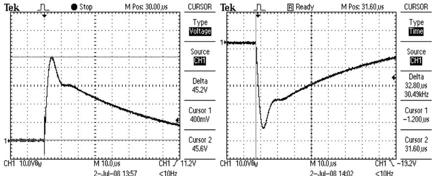
Рисунок 9 – Типовые осциллограммы предельного тока 2 комплекта 5 уровня положительной и отрицательной полярностей (1915 А)
