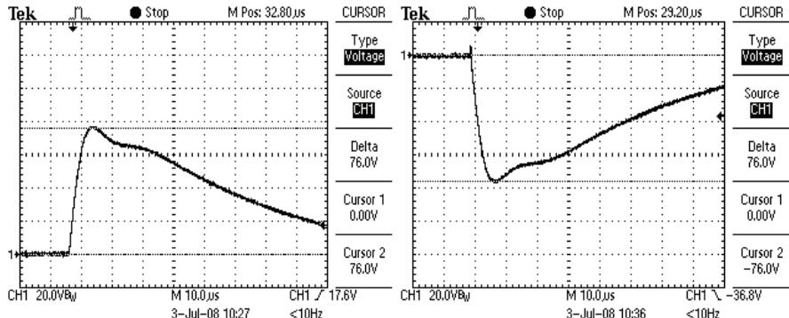
Рисунок 6 – Типовые осциллограммы испытательного тока 1 комплекта 5 уровня положительной и отрицательной полярностей (3220 А)
