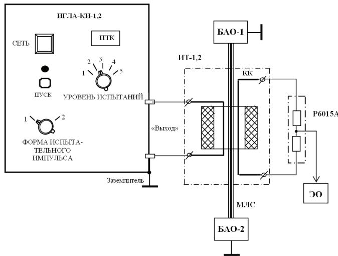
Рисунок 10 – Схема испытаний БАО с МЛС: Г-ИГЛА-КИ-1,2 – испытательный генератор; Р6015А – щуп высоковольтный Р6015А 1000Х; ЭО – осциллограф TEKTRONIX TDS1012; МЛС – межблочные линии связи; БАО-1, БАО-2 – испытываемое оборудование
