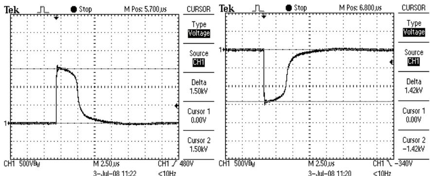
Рисунок 7 – Типовые осциллограммы предельного напряжения 1 комплекта 5 уровня положительной и отрицательной полярностей (1500 В)
