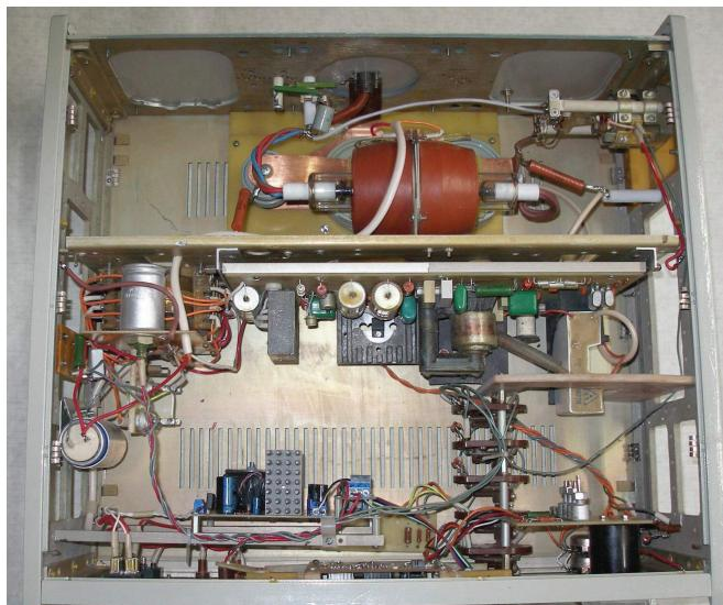
Рисунок 4 – Расположение элементов внутри корпуса генератора ИГЛА-КИ-1,2
