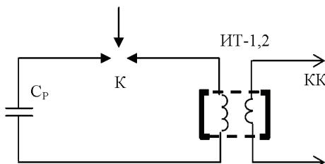
Рисунок 1 – Схема формирования импульсов напряжения и тока
