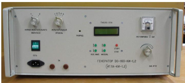
Рисунок 3 – Передняя панель генератора ИГЛА-КИ-1,2
