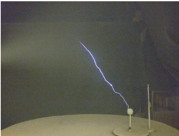
Рисунок 5 – Определение вероятности поражения разрядом из облака заряженного аэрозоля модели стержневого молниеотвода и модели защищаемого объекта
