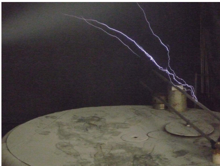
Рисунок 5 – Характерная картина поражения разрядом из облака заряженного аэрозоля модели тросового молниеотвода
