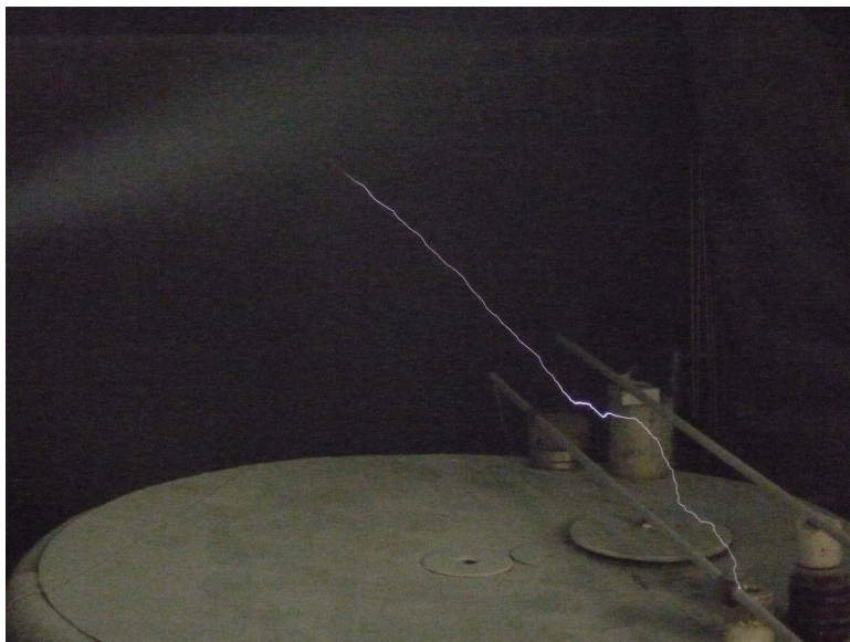
Рисунок 4 – Характерная картина поражения разрядом из облака заряженного аэрозоля модели защищаемого объекта (провода)
