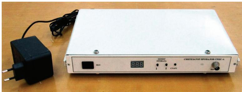
Рисунок 6 – Общий вид синтезатора провалов СПЦС-А
