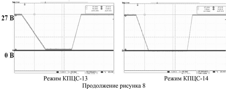
Методика испытаний БАО на КПЦС заключается в подаче на БАО двух последовательно следующих друг за другом провалов одной формы с интервалом 1 с (рис. 9).
