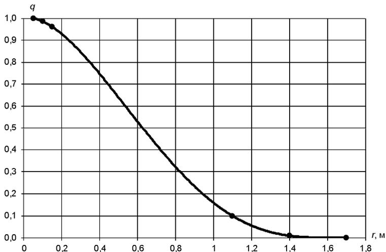
Рисунок 9 – График вероятности поражения молниеотвода для модели №3 при  $H = 3000$  мм,  $h = 300$  мм,  $h_1 = 150$  мм
