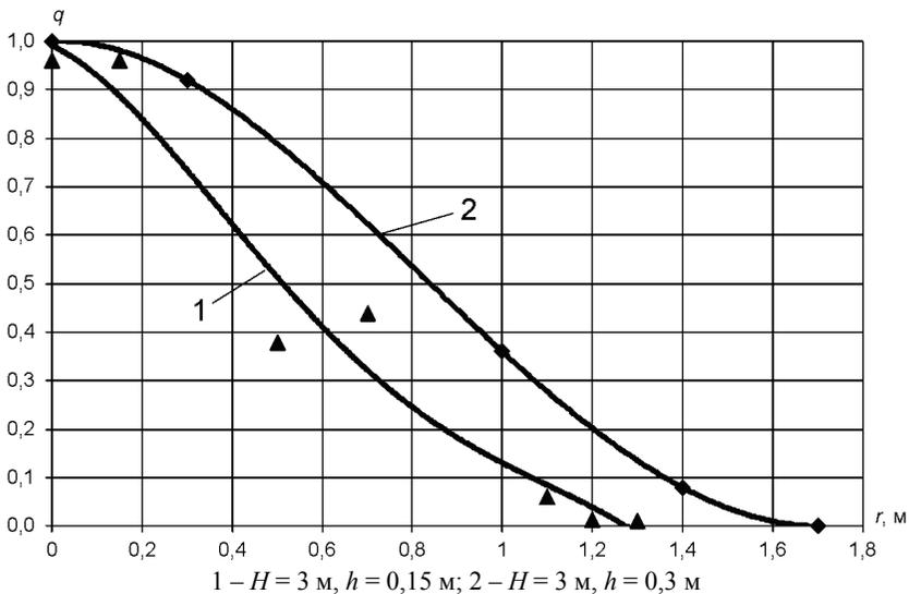
Рисунок 6 – График вероятности поражения молниеотвода для модели № 2
