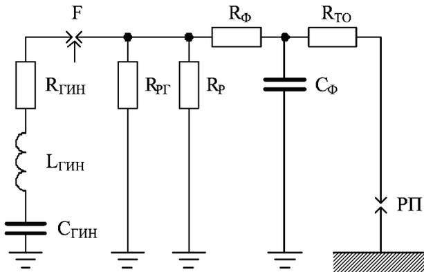
Рисунок 2 – Эквивалентная электрическая схема разрядного контура испытательного стенда:
