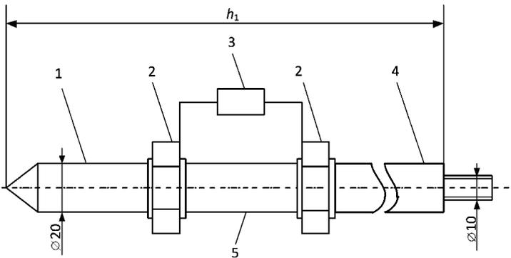
Рисунок 8 – Конструкция стержневого молниеотвода с РЭ:
