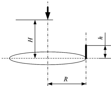
Рисунок 5 – Схема расположения стержня, имитирующего молниеотвод в модели №2
