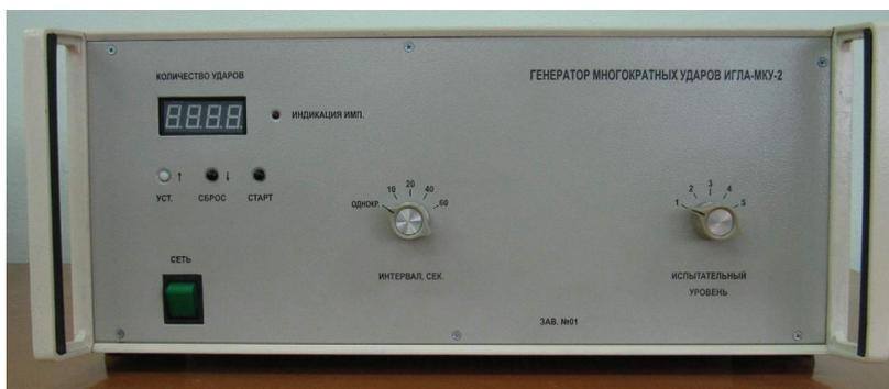
Рисунок 3 – Передняя панель генератора ИГЛА-МКУ-2
