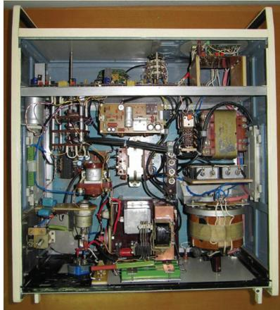
Рисунок 4 – Расположение элементов внутри корпуса генератора ИГЛА-МКУ-2
