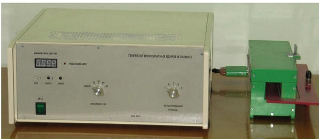
Рисунок 2 – Общий вид генератора ИГЛА-МКУ-2 с ИТ-1,2
