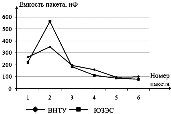
Рисунок 4 – Зависимость емкости пакета от номера пакета
