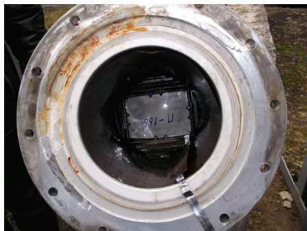
Рисунок 6 – Налет ржавчины в месте расположения верхней резиновой прокладки
