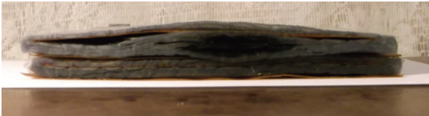
Рисунок 2 – Торцы 2-х секций с зоной почернения в средней части на участке контакта с гетинаксовой планкой
