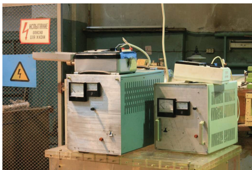
Рисунок 4 – Фотография низковольтный генераторов импульсов созданной электрофизической установки
