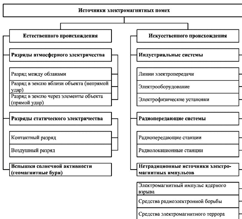
Рисунок 4 – Классификация источников электромагнитных помех
