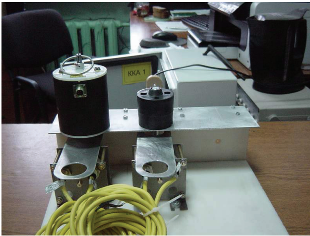
Рисунок 7 – Установка УБОП на неподвижной части привода электрооборудования: 1 – гайка М5 с шайбой, 2 – винты М5, 3 – неподвижная часть привода, 4 – шток, 5 – корпус УБОП
