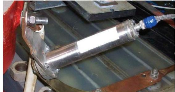
Рисунок 2 – Внешний вид омического коаксиального шунта
