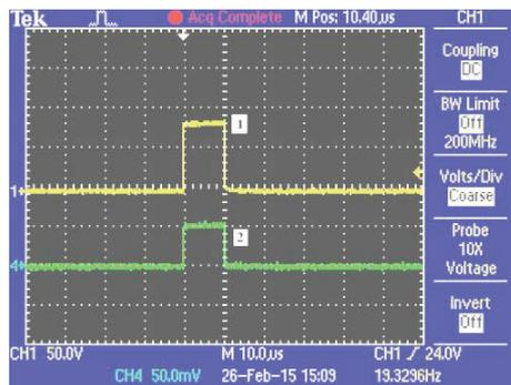
Рисунок 5 – Пример калибровки делителя прямоугольным импульсом низкого напряжения длительностью 10 мкс:
