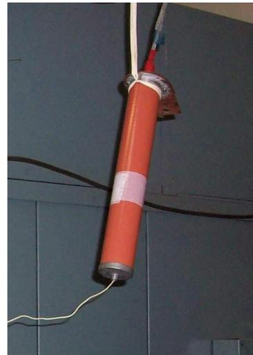
Рисунок 4 – Внешний вид емкостного делителя напряжения
