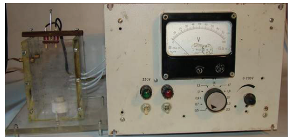
Рисунок 1 – Лабораторная установка для реализации СВС
