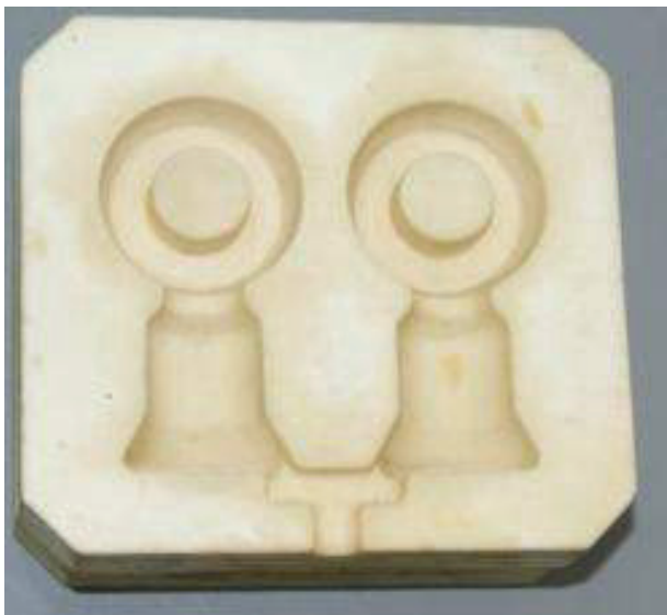
Рисунок 1 – Готовая пресс-форма, распечатанная на 3D-принтере
