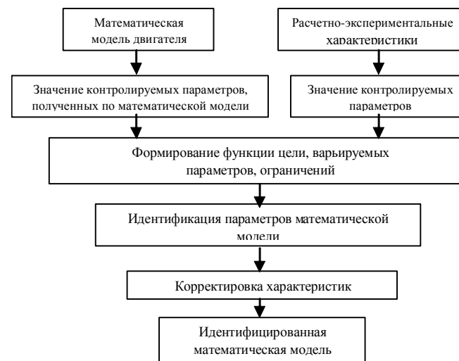
Рис. 5 – Структурная схема алгоритма идентификации математической модели
