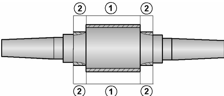
Рис. 2 – Схема удаления припуска с заготовки прокатного вала.
