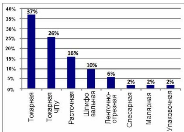
Рис. 1 – Распределение трудоемкости механической обработки прокатного вала по технологическим операциям.
