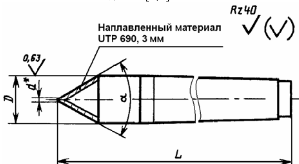
Рис. 1 – Биметаллический упорный центр.
