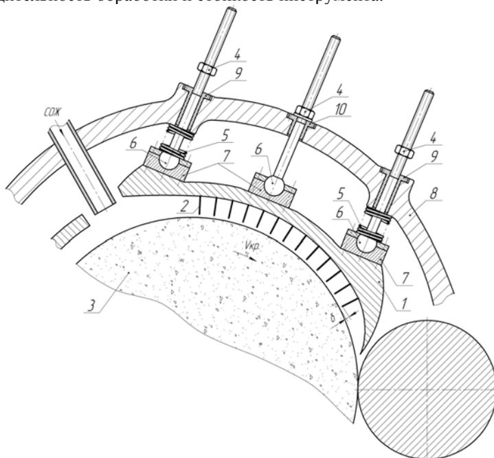
Рис. 10 – Устройство для подвода смазочно-охлаждающей жидкости
