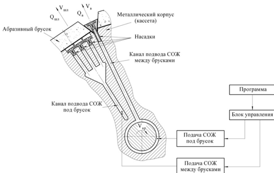
Рис. 5 – Подвод СОЖ по каналам шлифовального круга
