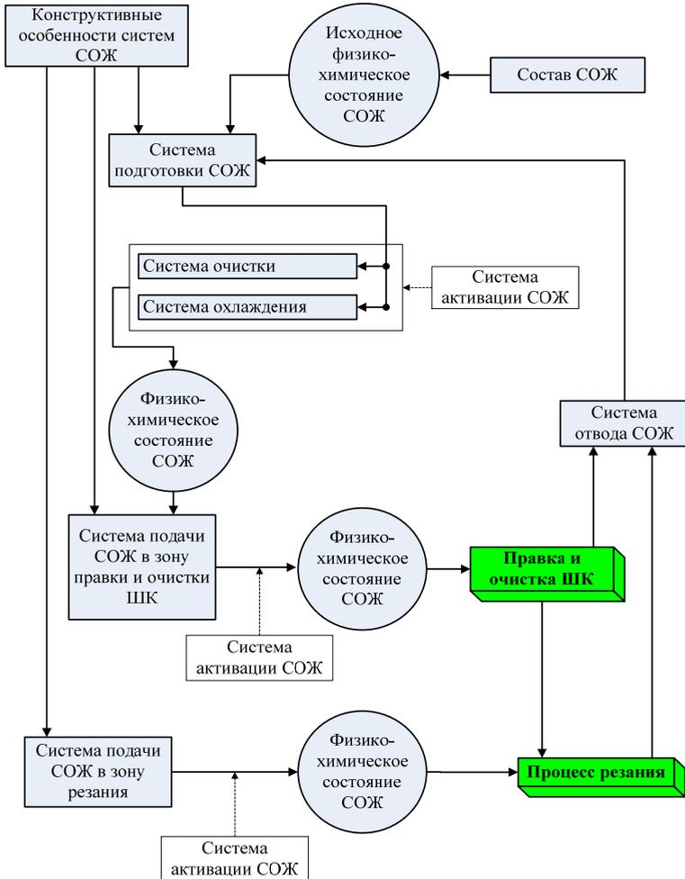
Рис. 3 – Структура технологической системы использования СОЖ при шлифовании
