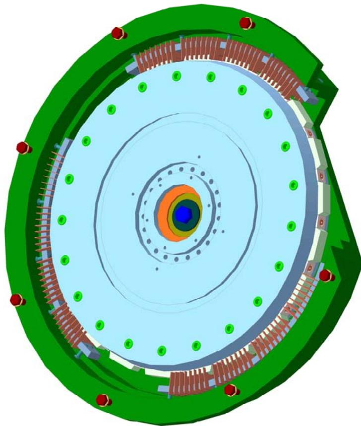
Рис. 13 – 3D-модель модуля сборного шлифовального круга
