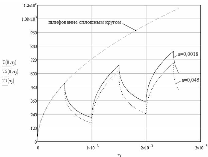
Рис. 1 – Сравнение температуры нагрева поверхности заготовки
