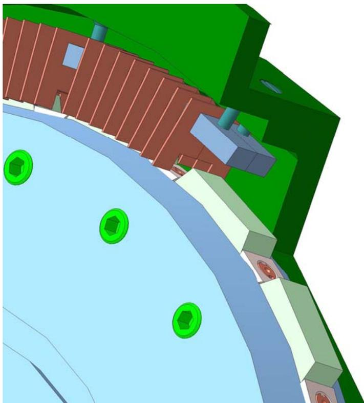
Рис. 15 – Упругие лепестки кожуха модуля
