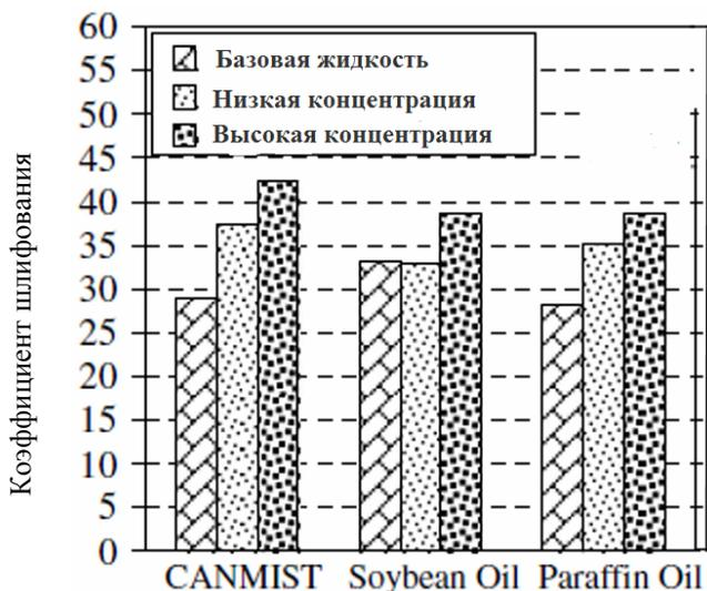
Рис. 2 – Влияние наночастиц  $MoS_2$  на коэффициент шлифования
