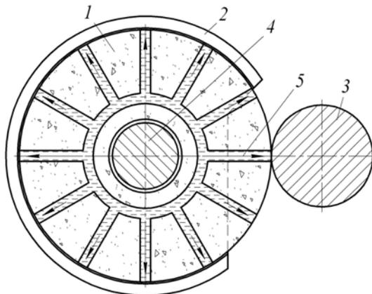
Рис. 4 – Подача СОЖ через каналы в абразивном материале
