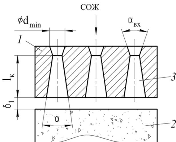
Рис. 9 – Подвод СОЖ через неподвижные сопла
