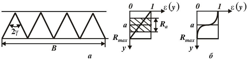
Рис. 1. Расчетная схема параметров шероховатости поверхности при абразивной обработке (а) и график функции  $\epsilon(y)$  (б).
