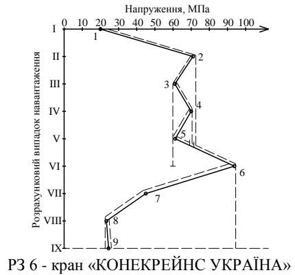
Рис. 3 – Схематизація зміни напружень в найбільш небезпечних розрахункових зонах при різних розрахункових випадках навантаження МК кранів методом «потоків дощу»
