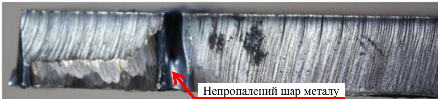
Рис. 5 – Непропалений метал при товщині листа 12 мм
